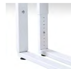
Noga biurka Q-eM -regulacja 10 mm (stopka) i 200 mm skokowo co 10 mm
